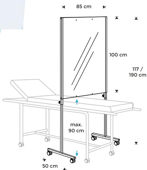
Pantalla protectora móvil y regulable en altura diseñada especialmente para dar solución a los centros de estética, podólogos, etc en los que sea necesario salvar camas o camillas. Medida interior de 80cm. Robusta estructura realizada en tubo de acero. Pantalla realizada en metacrilato de 1,5mm de espesor. Protección ante cualquier estornudo, previene la infección por transmisión de gotas. Ruedas con freno.
