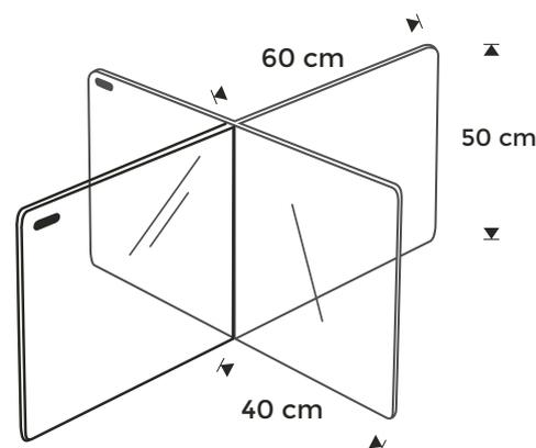
Paneles separadores acrílicos transparentes de 5mm de espesor pensados para hostelería (restaurantes y cafeterías) proporcionando una máxima protección entre los comensales.
